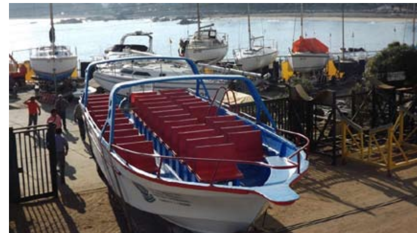
Embarcación para paseos. Capacidad para 34 pasajeros. Posee dos motores fuera de borda. Esta fue entregada en Papudo.
