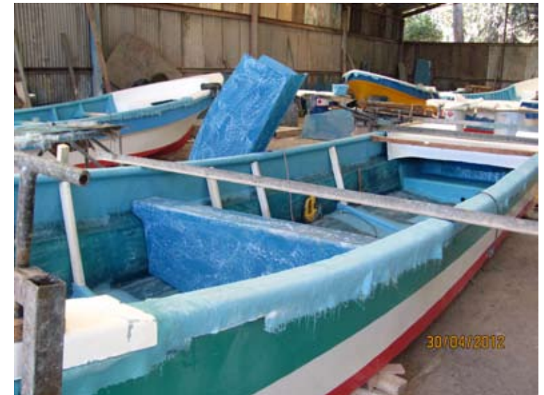
Imagen de un molde de fibra y con el laminado ya hecho.
