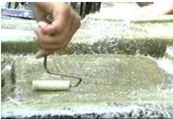
Compactación con un pequeño rodillo
