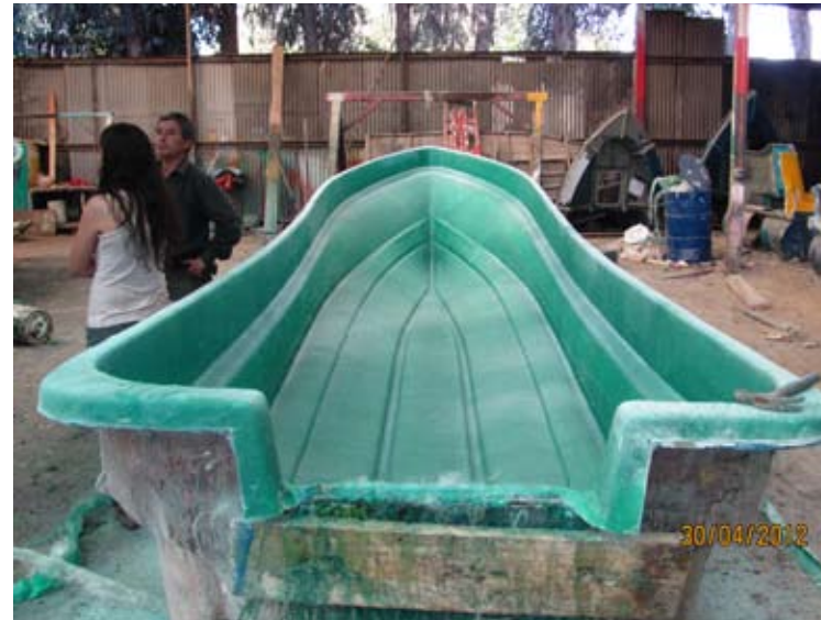
Molde de fibra de vidrio terminado
