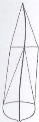
Figura 10. Si un pilar se empotra en sus extremos de forma que se fuerza su geometría fuera de su alineación, su carga crítica puede bajar de valor, ya que el cordaje del aparejo se suele tensar y producir flexiones en el mástil. Por eso ya no se fijan los mástiles a la vez al puente y a la quilla.
