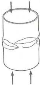
Figura 12. Pandeo local o de "Brazier" de un soporte de tubo de pared delgada bajo compresión centrada.
