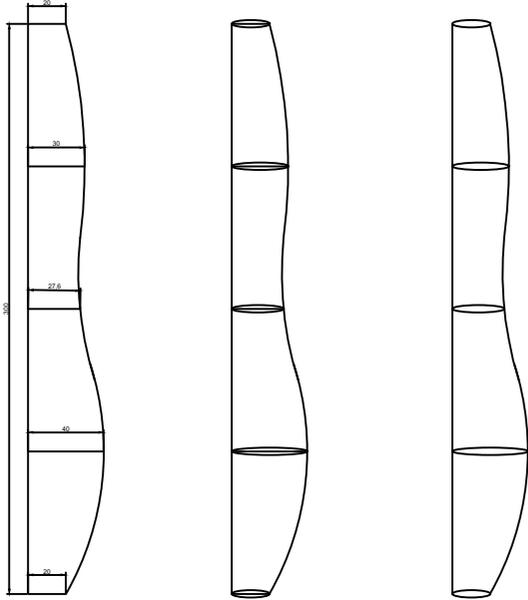
Para el modelo decido las medidas de diámetros por las que me guiaré para el total proyectado. Decido una curvatura mayor en la parte inferior para que esta resista mejor el peso superior. En la parte superior dibujo un diámetro menor siguiendo lo antes mencionado. El diámetro del centro busca estar en un intermedio entre ambas curvaturas, para dar este efecto, debe ser menor que ambas, y mayor que su base para que resista su volumen total.
