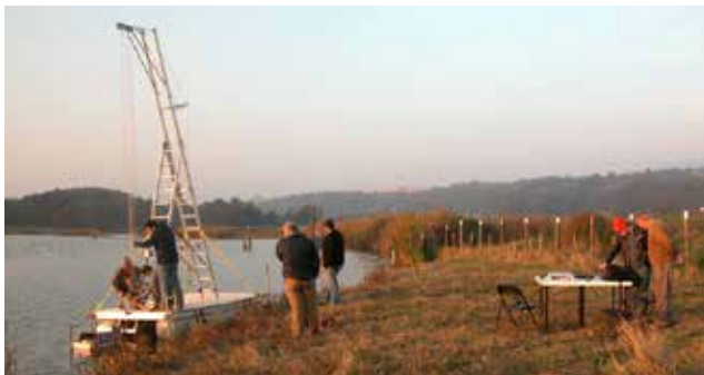
Sistema de arrastre en canal estero Mantagua, con registro de velocidad y fuerza a traves de software
