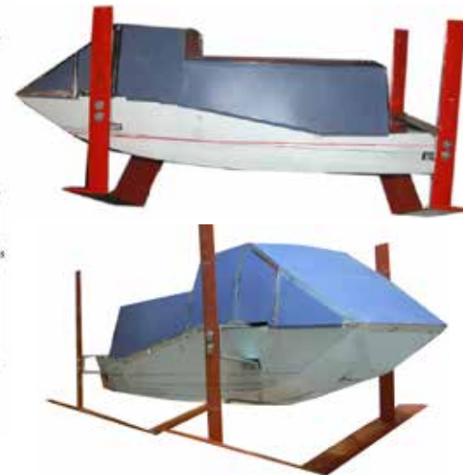
Modelo Hidrofoil con posición de los perfiles rectificados y carcaza de aluminio
