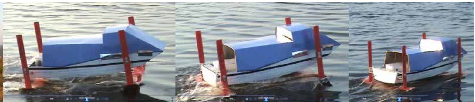
Sistema de arrastre en canal estero Mantagua, con registro de velocidad y fuerza a traves de software
