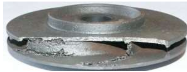
Desgaste producido por la cavitación en un rodete de una bomba centrífuga
