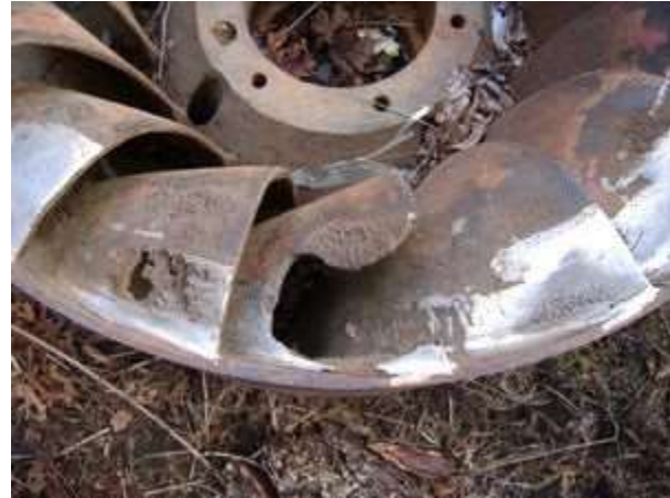
Daño por cavitación de una turbina Francis
