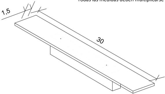
~El armado de la viga se realiza de manera horizontal, por lo que el moldaje se configura como una mesa alineada paralelamente con otra a una distancia de 2.3 cms.
