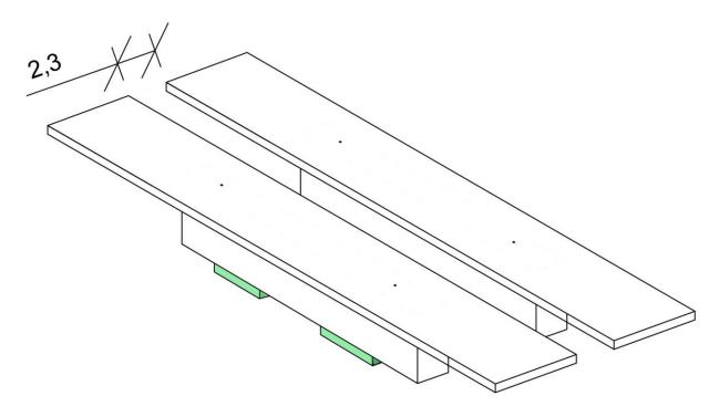
~Para asegurar el paralelismo de las mesas, se clavan dos trozos de trupan o cualquier madera (Seción verde Figura) de un grosor uniforme por la parte inferior de los soportes de los trupanes superiores.
